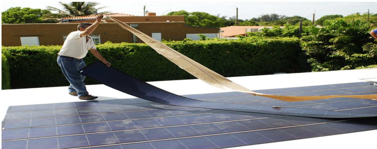
चित्र 5: पतली परत (thin-film) तथा लचीली सौर कोशिकाओं का आधुनिक तकनीकी स्वरूप। इनमें CdTe, CIGS तथा अमोर्फस सिलिकॉन (a-Si) की 1-2 \mu\text{m} मोटी परतें प्रयुक्त होती हैं [3]।
