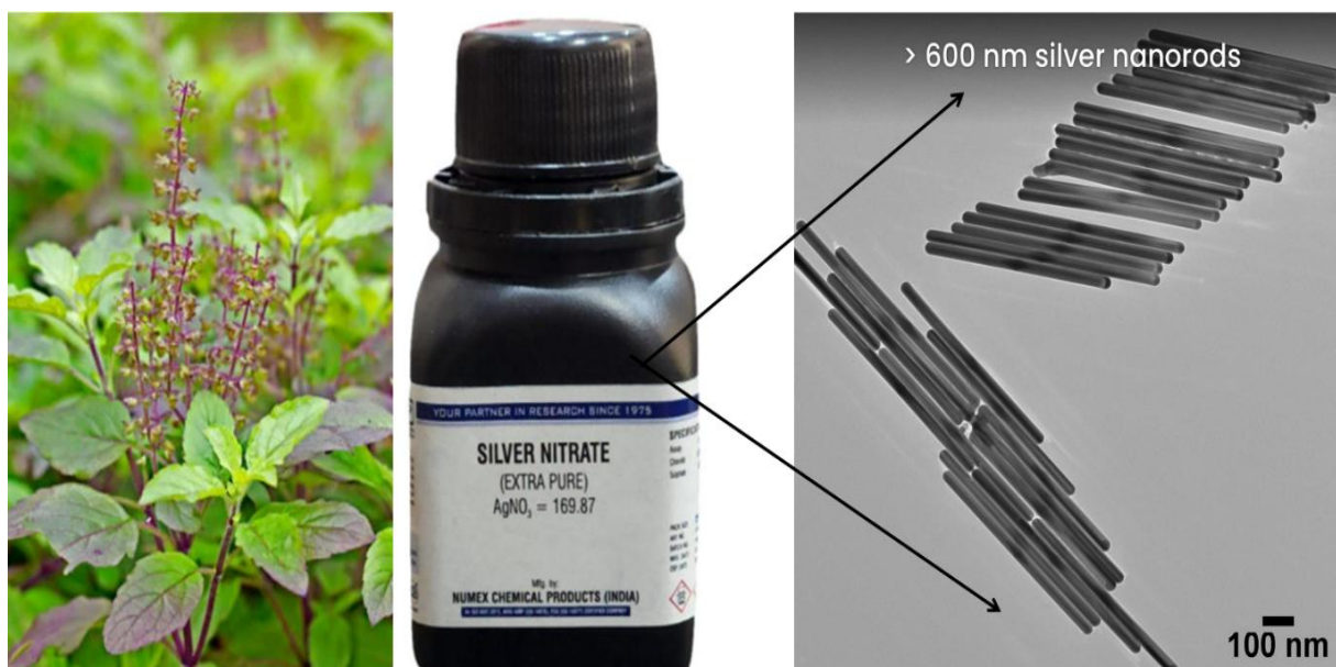
चित्र 1: तुलसी ( Ocimum sanctum ) के अर्क और सिल्वर नाइट्रेट ( \text{AgNO}_3 ) से सिल्वर नैनोरोड्स की हरित संश्लेषण योजना
