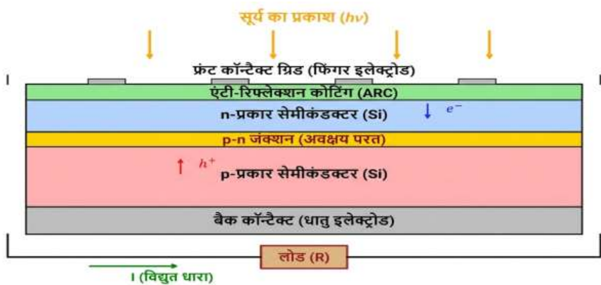
चित्र 3: सौर कोशिका की परतीय संरचना: परावर्तन-रोधी लेपन (ARC), एन-प्रकार अर्धचालक, पी-एन संधि (अवक्षय परत), पी-प्रकार अर्धचालक, पश्च संपर्क, अग्र संपर्क ग्रिड, बाह्य भार (R), तथा विद्युत धारा (I) का प्रवाह पथ दर्शाया गया है। (स्व-रचित आरेख)
