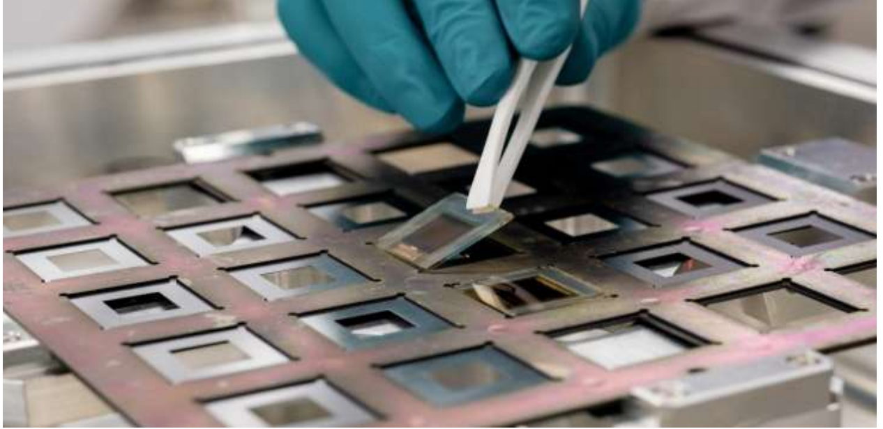
चित्र 7: प्रयोगशाला में निर्मित पेरोव्स्काइट सौर कोशिका की सूक्ष्म संरचना। पेरोव्स्काइट कोशिकाओं में ABX_3 क्रिस्टल संरचना (जहाँ A = CH_3NH_3^+/Cs^+ , B = Pb^{2+}/Sn^{2+} , X = I^-/Br^-/Cl^- ) का उपयोग प्रकाश अवशोषक परत के रूप में किया जाता है। इनका बैंड गैप (1.2-2.3 eV) समायोज्य होता है [9]
